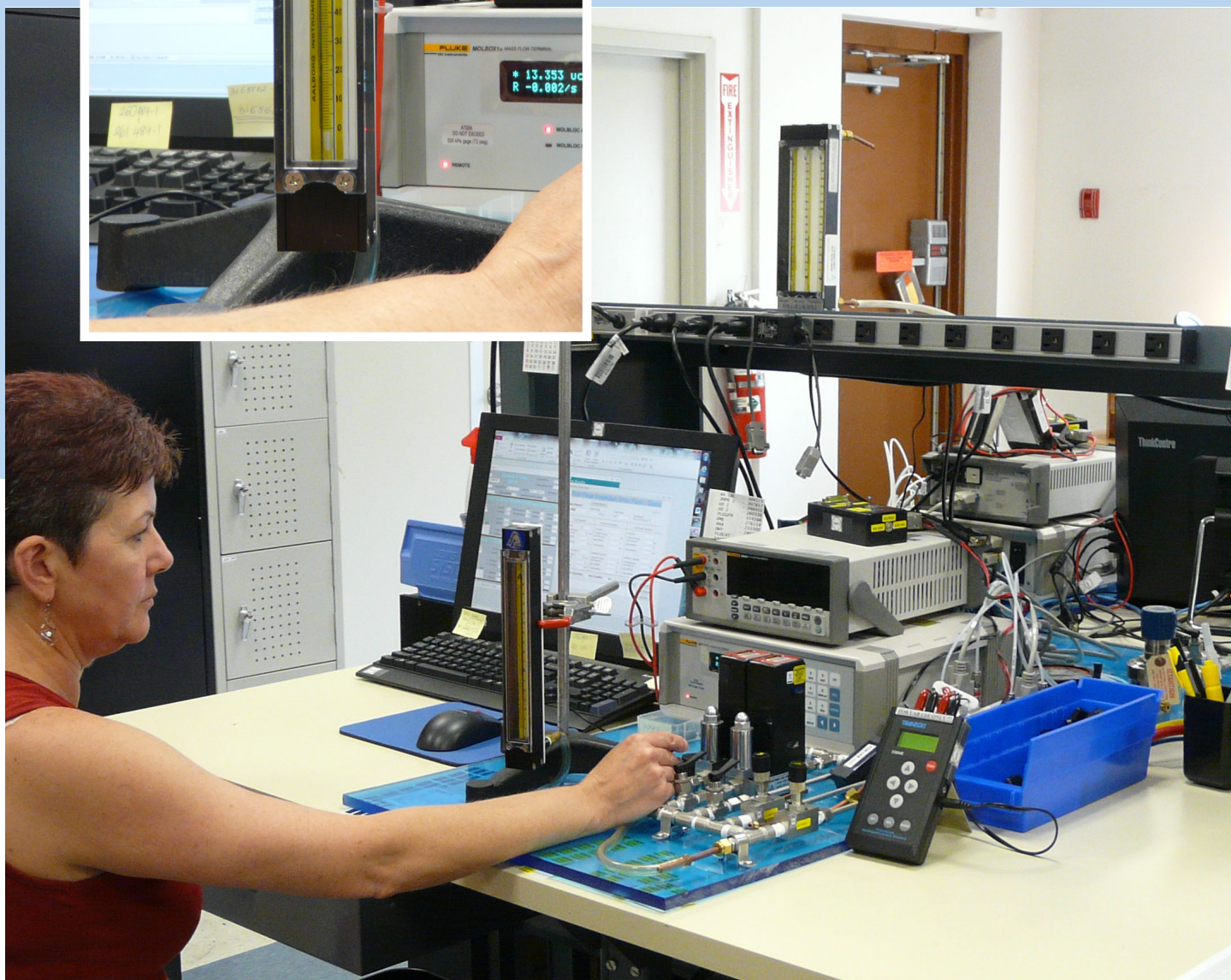
Zur Kalibrierung in Aalborgs Labor zurück- gegebener Strömungsmesser eines Kunden.
