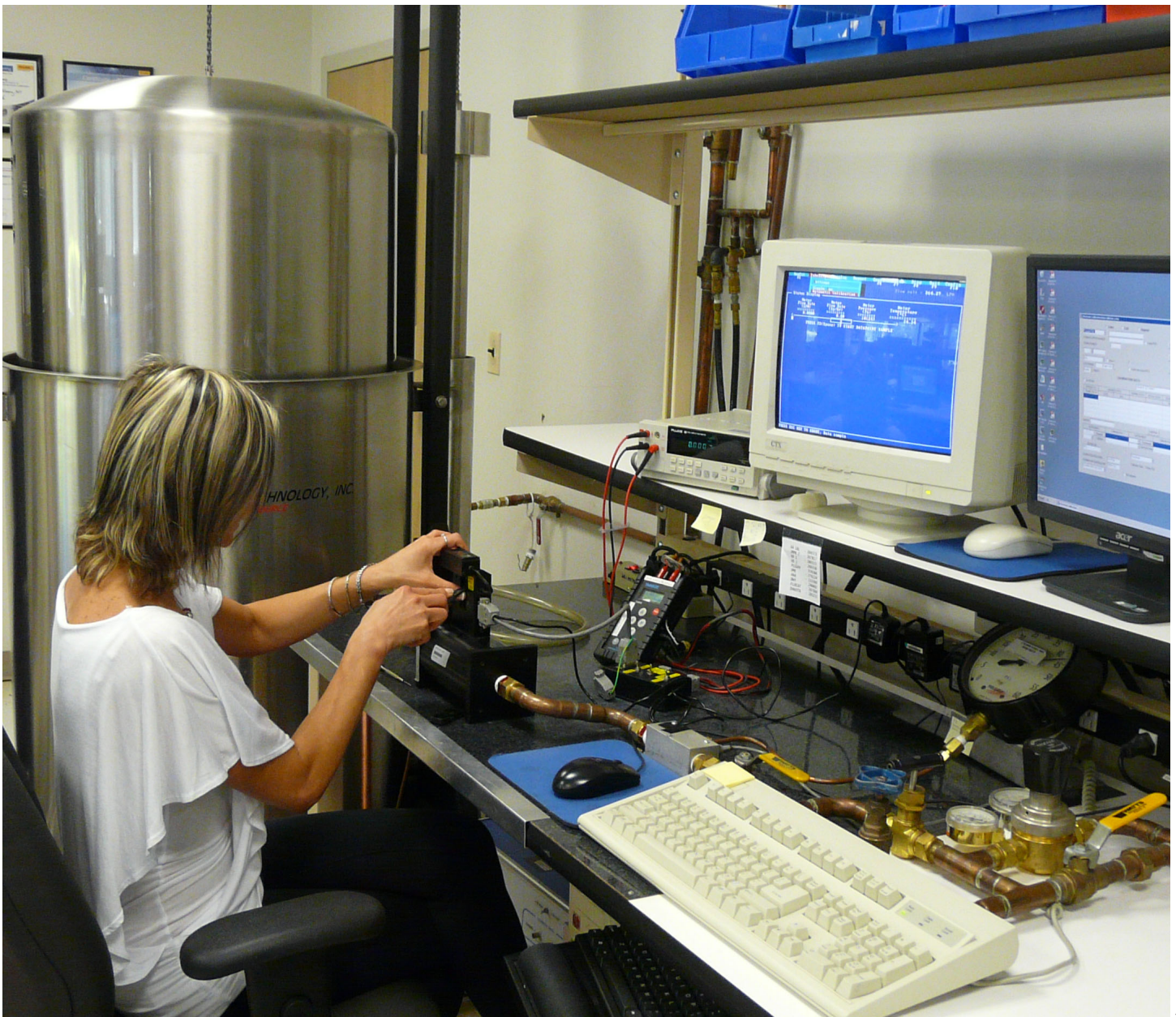
Benutzung eines Bell Prover durch einen Techniker beider Kalibrierung eines Durchflussmessers mit hoher Durchflusskapazität.
